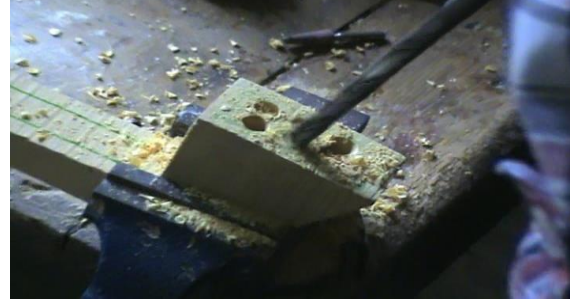
Resim 6. Kepçe Bölümünün Matkap Yardımıyla Oyulması
