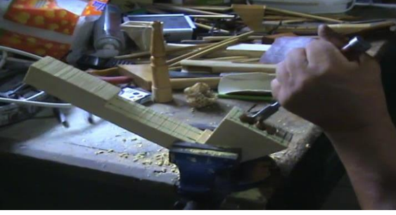
Resim 7. Iskarpela yardımıyla kepçenin iç kısmının genişletilmesi
