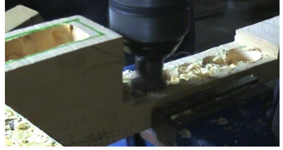
Resim 8. Matkap yardımıyla analık yatağının açılması
